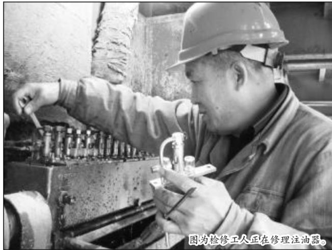
图为检修工人正在修理注油器。
