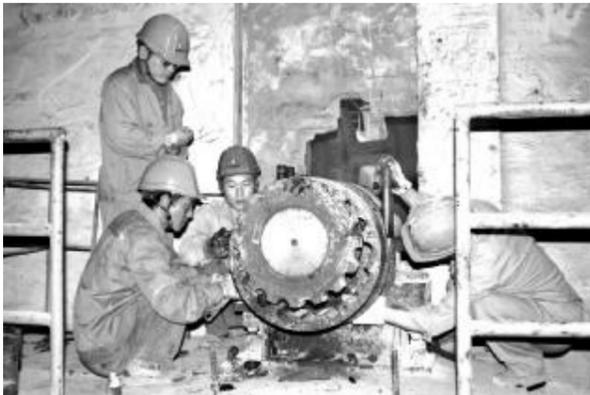
日前,检修分厂电机车间开始对氧化铝二号原料磨同步机进行常规大修。这次大修主要施工任务是调整定转子气隙,更换联轴器,检修轴瓦,同时根据工艺系统将重达近五吨的同步机整体移位十毫米,预计工期九天。图为检修员工对传动轴承座进行检修。
